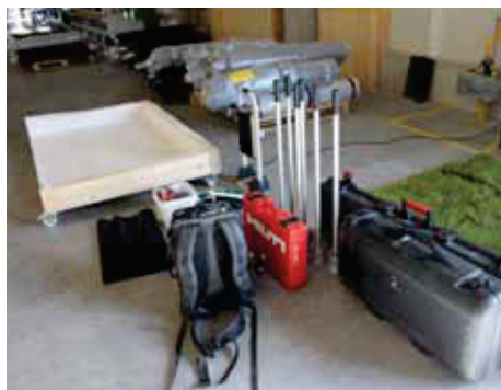
Ausrüstung für das Verschweißen von EPDM-Dachbahnen per Induktion („RhinoBond-System“)
