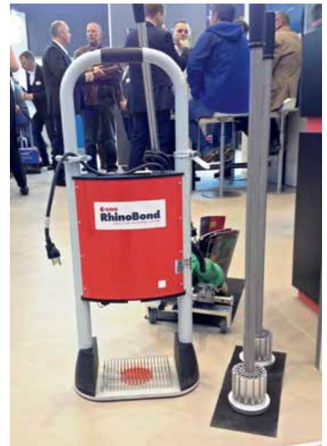
Das Induktionsgerät (links) und die Kühlkörper
